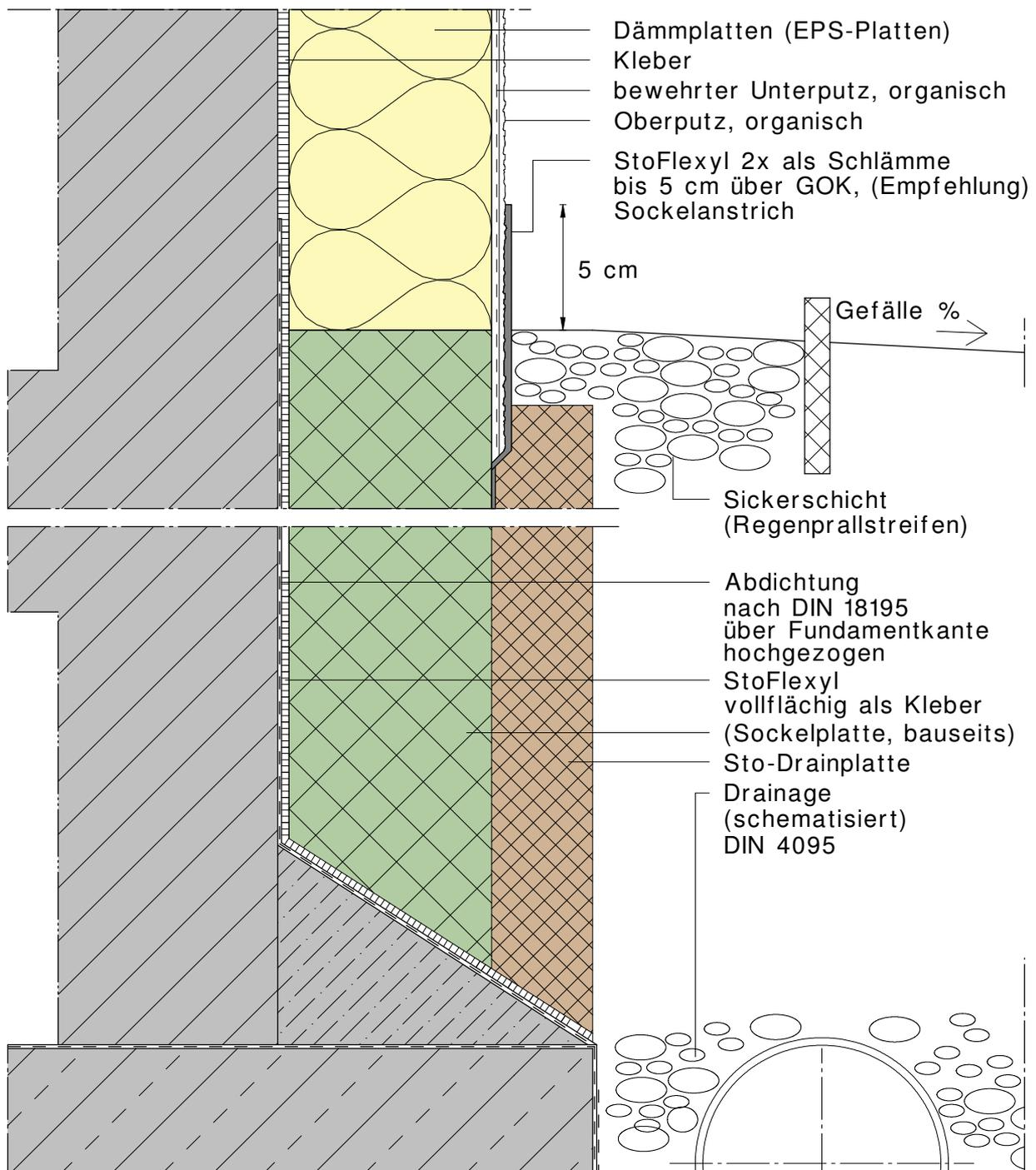
Die Festlegung der GOK erfolgt vor der Ausführung der Dämmung und Abdichtungsarbeiten durch den Planer
